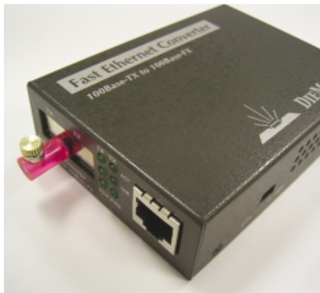
Der Fast-Ethernet-Medienkonverter für Simplex-POF enthält intern einen optischen Splitter, der die beiden Signale zusammenführt
