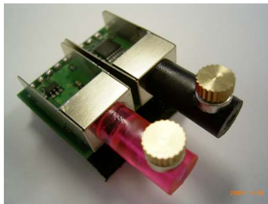
Bild 8: Optischer Transceiver mit standardisierter 1x9-Schnittstelle der Fa. DieMount
